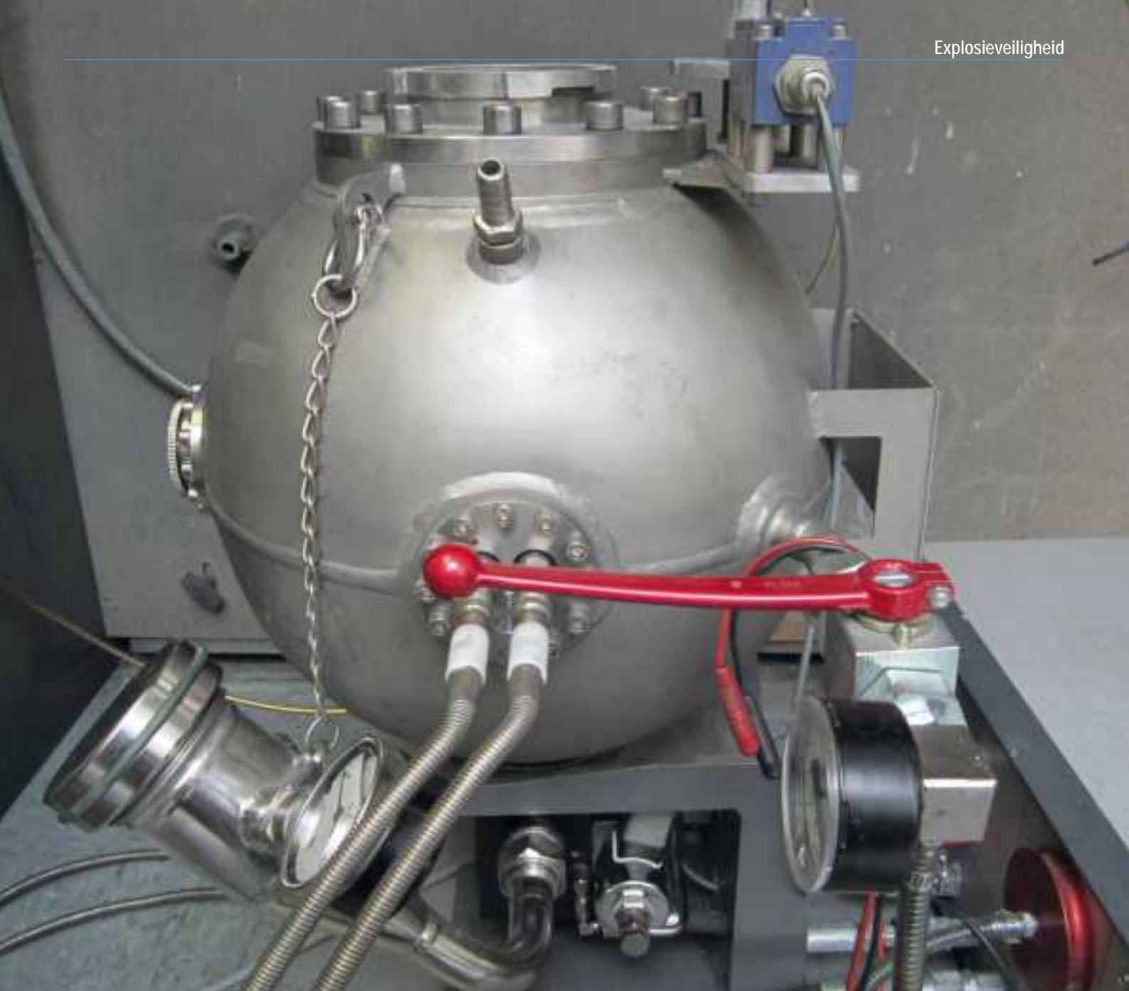
Afb. 1 De 20 liter-bol (R. Siwek) voor het testen van poeders op hun explosieve eigenschappen
